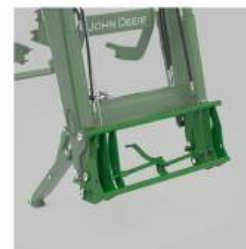
커플러 · 안정적이고 편리한 원레버 퀵 커플러 · ISO 23206 유로히치 커플러를 적용하여 다양한 작업기 장착 가능
