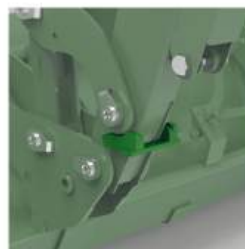
버킷 스톱퍼 · 버킷 스톱퍼 적용으로 버킷 및 실린더 보호 및 안정적인 작업 구현
