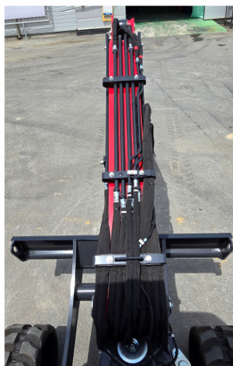
간섭을 최소화한 호스 디자인 작업 장치 상단에 파이프 적용으로 유압호스 최소화 및 호스 교체가 용이
